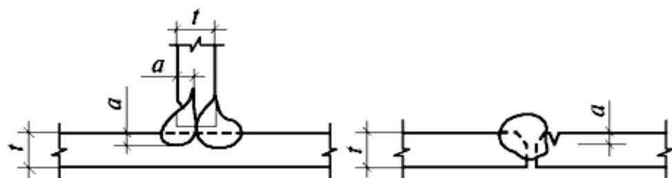
Рис. 3. Подрезы основного металла угловых и стыковых соединений
